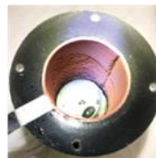
剥離前のカソード
